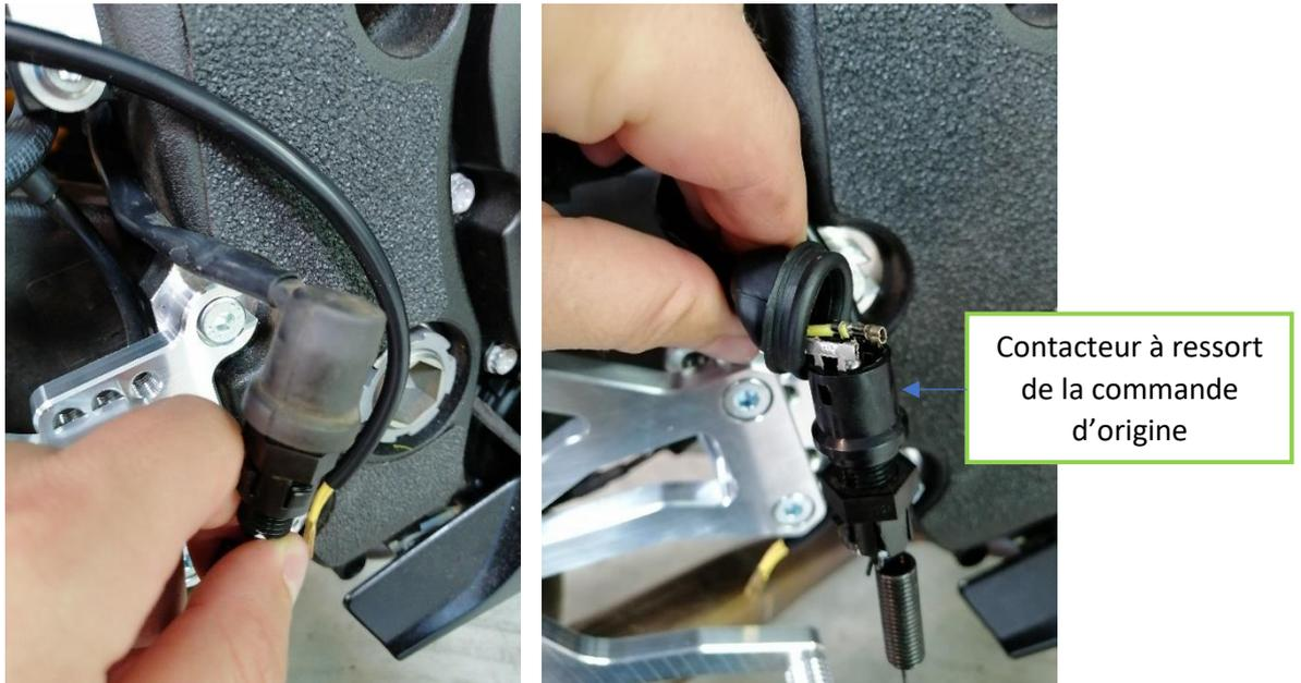
**11.4.** A l'aide d'une pince coupante venir sectionner les 4 attaches des cosses femelles du contacteur à ressort d'origine. Une fois coupées retirer totalement la protection caoutchouc.
