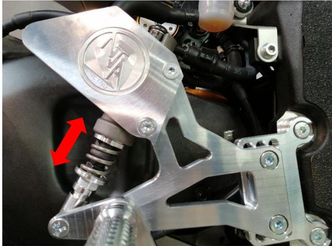
Commande reculée côté frein montée
